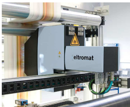
Abb. 1: Bahnbeobachtungs- und Inspektionssystem für hochdynamische Prozesse
